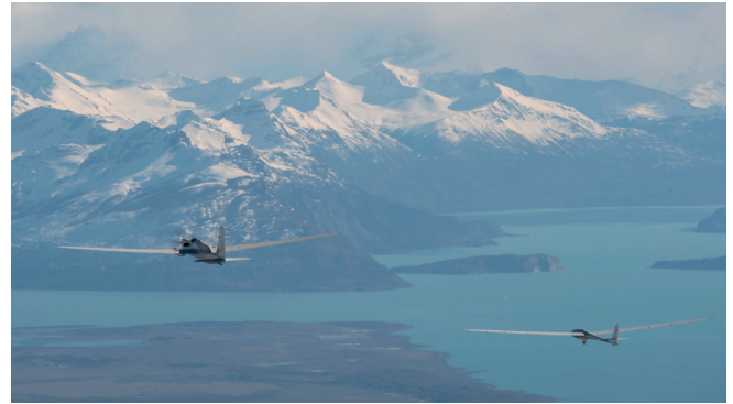
Abb. 1: Das Segelflugzeug Perlan 2 (rechts) wird von der Grob Egrett (links) bis in die untere Stratosphäre geschleppt (© Airbus International/Perlan).
